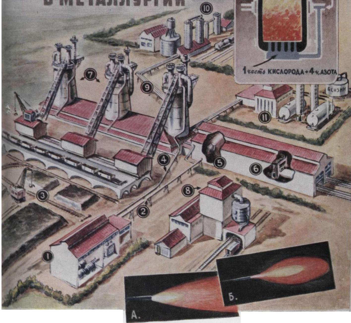
КИСЛОРОД находит все более широкое применение в металлургии. Вдувая в доменные и сталеплавильные печи кислород или обогащенный им воздух, удается ускорить процессы получения чугуна и стали, повысить качество выплавляемого металла.
