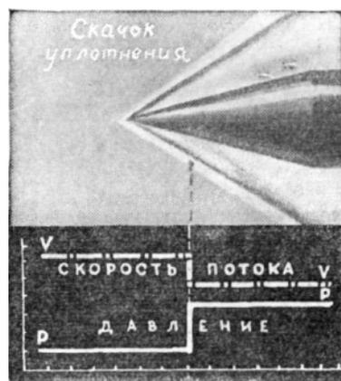
Образование скачка уплотнения при обтекании конического тела сверхзвуковым потоком воздуха и изменение скоростей и давлений в струйке до и после скачка.
